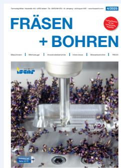
Gebr. Recknagel Präzisionsstahl war auf der Suche nach einem Werkzeug, mit dem der Halbzeughersteller Taschen und Kavitäten einfach, prozesssicher, schnell und wirtschaftlich in Werkzeugstähle einbringen kann. Werkzeugpartner ISCAR hatte schnell die Lösung parat: Den MILL4FEED-Hochvorschubfräser, bestückt mit den neuen 06er-FFQ4-Wendeschneidplatten aus ISCARs LOQUIQUICK-Kampagne.
